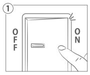
照明器具の主電源をOFFにして、 再度ONにします。
