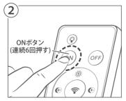
主電源をONにした直後にリモコンのONボタンを素早く連続で6回押してください。(必ず主電源をONにした直後にボタンを押してください。)
