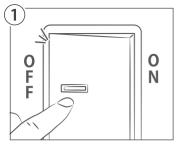
照明器具の主電源をOFFにします。 ※アプリからのOFFではなく、必ず壁スイッチなどの主電源でOFF にしてください。
