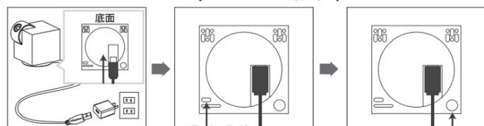
①本体の底面にUSB Type-CケーブルのType-Cコネクタを差し込み、ACアダプターの方にもう片方を繋いで、コンセントに差し込む。
