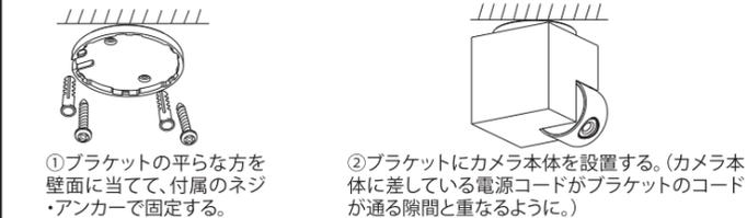
※取り付けの壁厚が25mm以上あるか確認をしてください。壁厚が25mm以上ない場合は、カメラの自重での落下を防ぐため、壁の裏面に当板を使うなどして補強をしてください。
