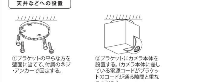
※取り付けの壁厚が25mm以上あるか確認をしてください。壁厚が25mm以上ない場合は、カメラの自重での落下を防ぐため、壁の裏面に当板を使うなどして補強をしてください。
